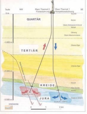
Die Förderbohrung wurde auf eine Endteufe von 3225 m (entspricht 2746 m vertikal) niederbebracht, die Reiniektionsbohrung erreichte 3275 m (entspricht 3020 m vertikal). Bild: Endwerk
