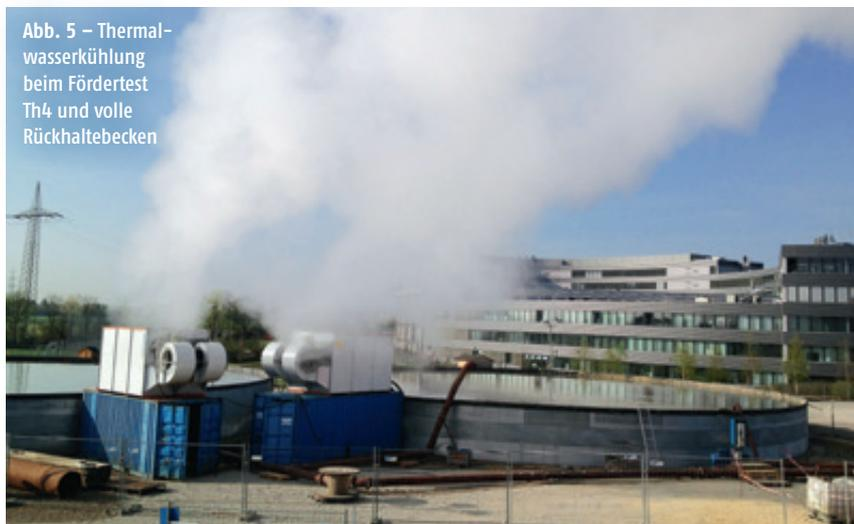
Abb. 5 – Thermalwasserkühlung beim Fördertest Th4 und volle Rückhaltebecken
