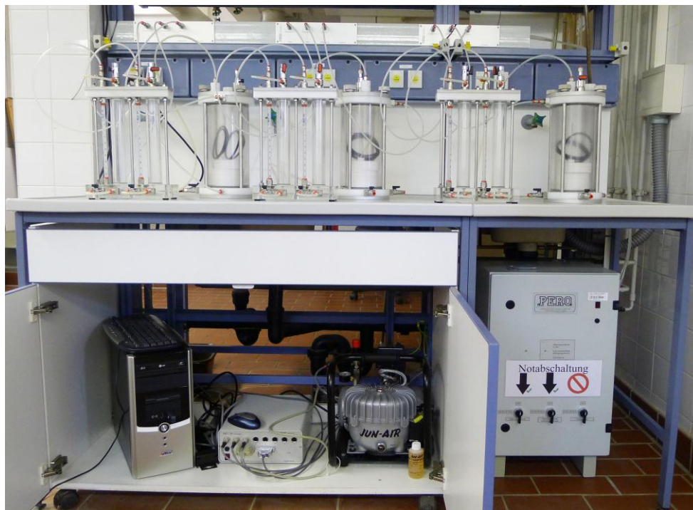
Abb. 6.3: Aufbau des Hochdruckpermeameters. Das Gerät setzt sich aus Druckerzeuger (Kompressor – unten Mitte), Druckregeleinrichtung (unten rechts), Schaltleiste (oberer Bildrand) und den drei Messplätzen, jeweils bestehend aus Bürettenblock und Triaxialzelle, zusammen. Die Ansteuerung und Datenaufzeichnung erfolgt mittels eines PCs und eines angeschlossenen Datenloggers (unten links).
