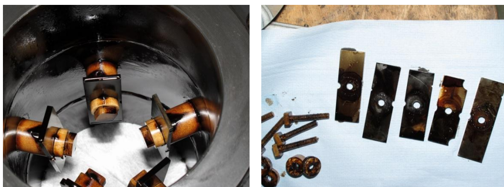
Abb. 8.6: Teststrecke bei Ausbau (a) links, mit Ölfilm versehene Teststücke (b) rechts
