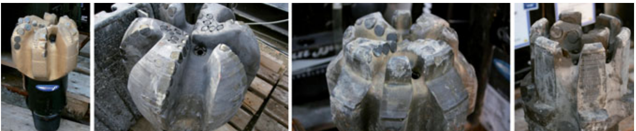
Abb. 8 Verschlissene PDC-Meißel, links im Neuzustand
