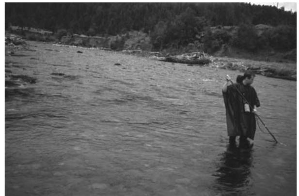
Abflussmessung am Río Contrafuerte
