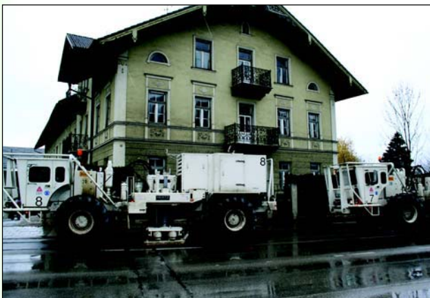
Abb. 1: Seismische Messungen auf der Münchner Straße im Ortszentrum von Unterföhring. Quelle: Erdwerk GmbH, 2007
